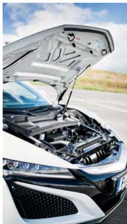
Le compartiment avant est largement encombré par le gestionnaire de puissance et les deux moteurs électriques.
