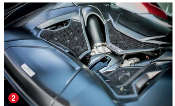
1 & 2 | Hondamen, start your engines! Hybride, la NSX met à contribution 3 moteurs électriques en plus du V6 de 3,5 litres. De quoi porter la puissance combinée à 581 ch.
