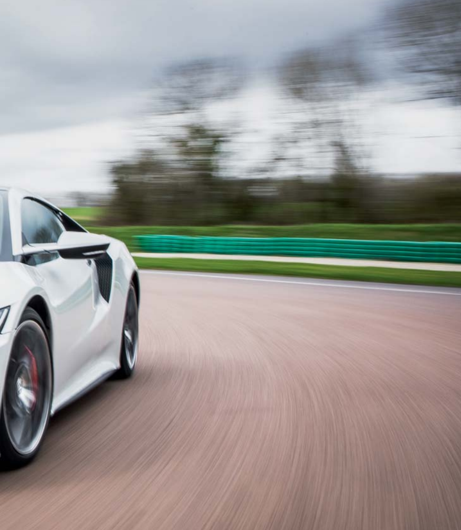
1 & 2 | Hondamen, start your engines! Hybride, la NSX met à contribution 3 moteurs électriques en plus du V6 de 3,5 litres. De quoi porter la puissance combinée à 581 ch.
