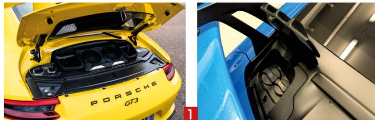
1. Sur la 991, on peut encore ouvrir un capot moteur ! Impossible sur la 992, vu la configuration de l'aile : il ne reste plus qu'une petite trappe pour les remplissages !
